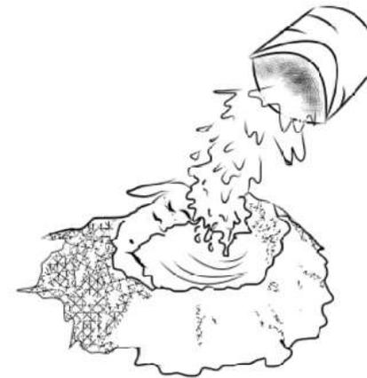
Cuando se obtenga un color uniforme en la mezcla se le agregara la gravilla y se continuara mezclando. Finalmente se hace un arrume en forma de cono para incorporar el agua y se mezcla hasta que el agua se distribuya bien. La forma de comprobar que la humedad que tiene la mezcla es la adecuada, es coger un poco de la mezcla en la mano y apretarla fuertemente, al hacer esto la mezcla debe de quedar apelmazada sin escurrirse. En caso de que el puñado se desmorone se le deberá de agregar más agua.
